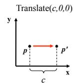
$$\begin{pmatrix} x' \\ y' \\ z' \\ 1 \end{pmatrix} = \begin{pmatrix} 1 & 0 & 0 & t_x \\ 0 & 1 & 0 & t_y \\ 0 & 0 & 1 & t_z \\ 0 & 0 & 0 & 1 \end{pmatrix} \begin{pmatrix} x \\ y \\ z \\ 1 \end{pmatrix}$$
